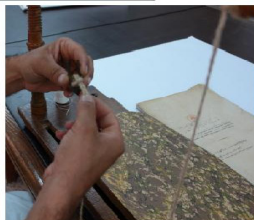
تثبيت شرائط الحياكة في الكلافيت و وضعها أسفل الآلة
